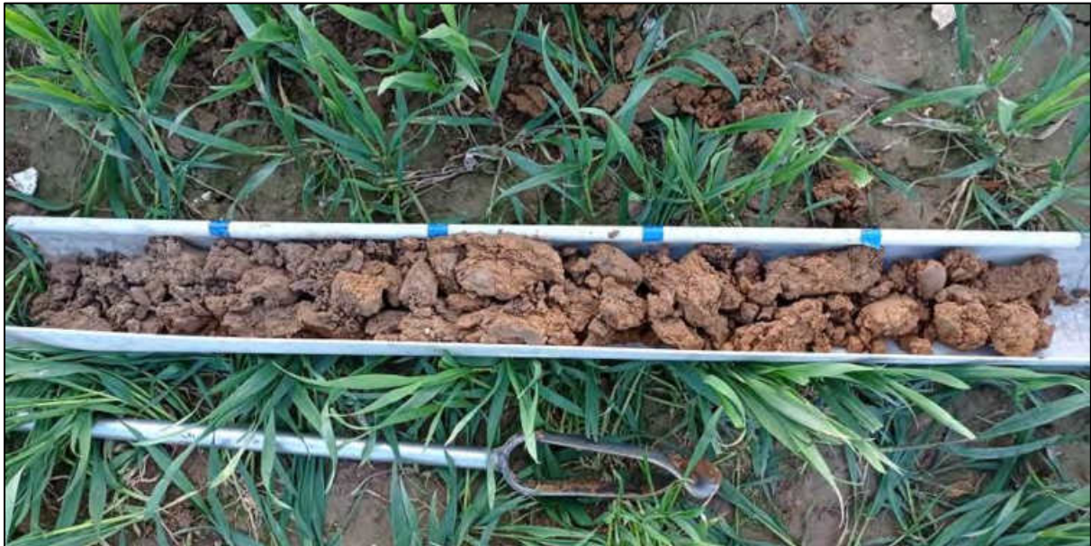
Figure 9 : Profil typique des sondages réalisés sur le site à 1 mètre de profondeur
