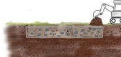
La tranchée drainante
