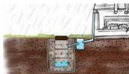
Le puits d'infiltration
