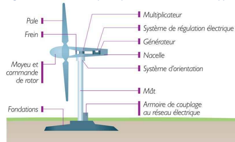
Figure 3 : Schéma de principe d'une éolienne de type aérogénérateur
