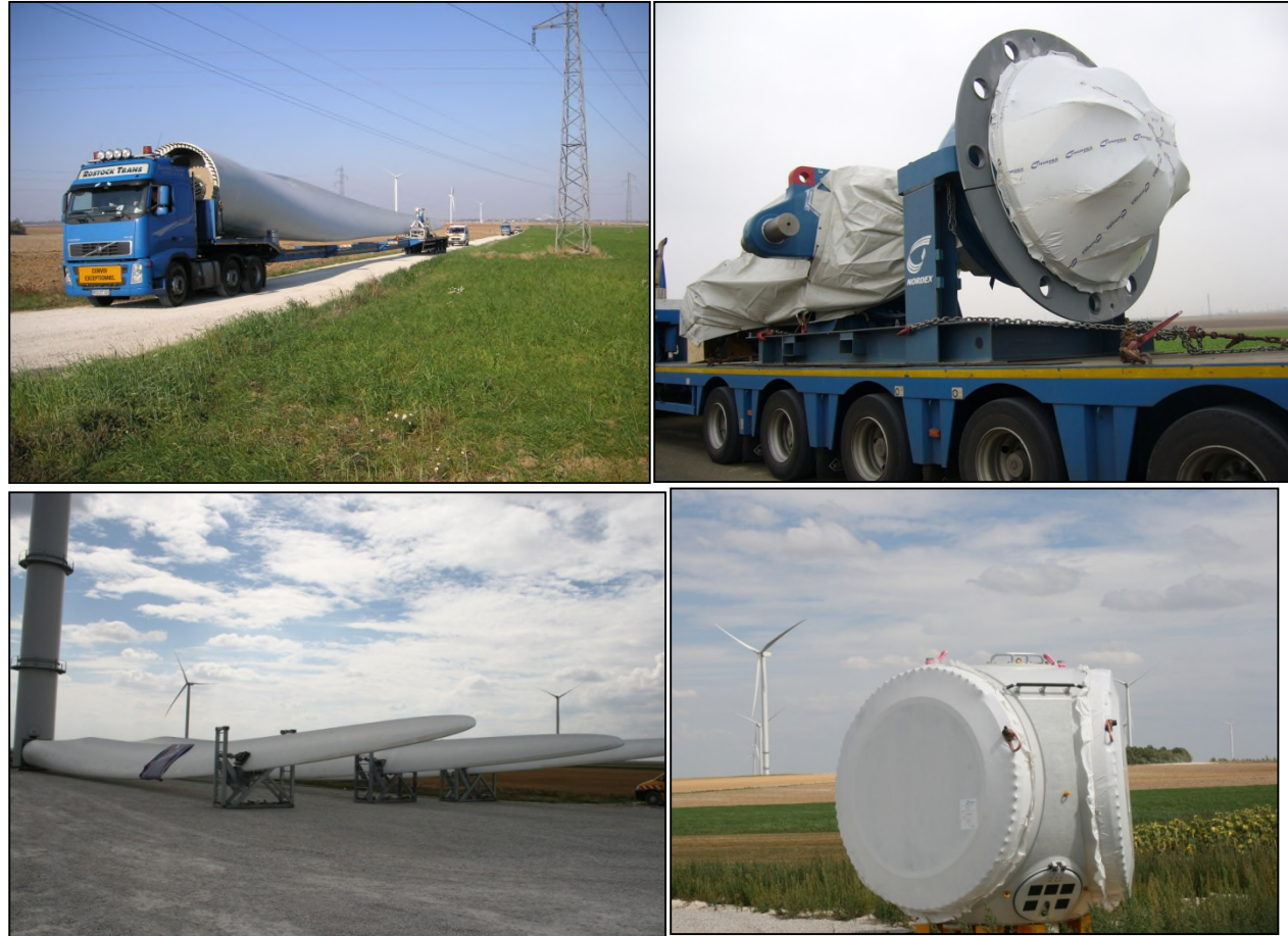
Figure 22 : Acheminement et stockage des éléments de l'éolienne
