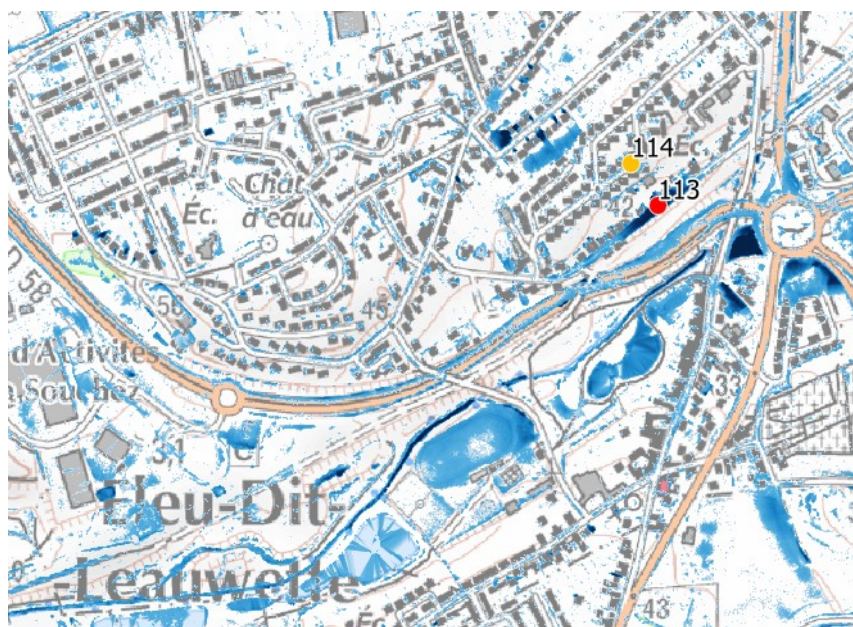
Figure 55 : Axes d'écoulement, zones d'accumulation (résultats bruts) et écarts aux repères de crue sur la commune d'Eleu-dit-Leauwette pour l'évènement de juin 2016
