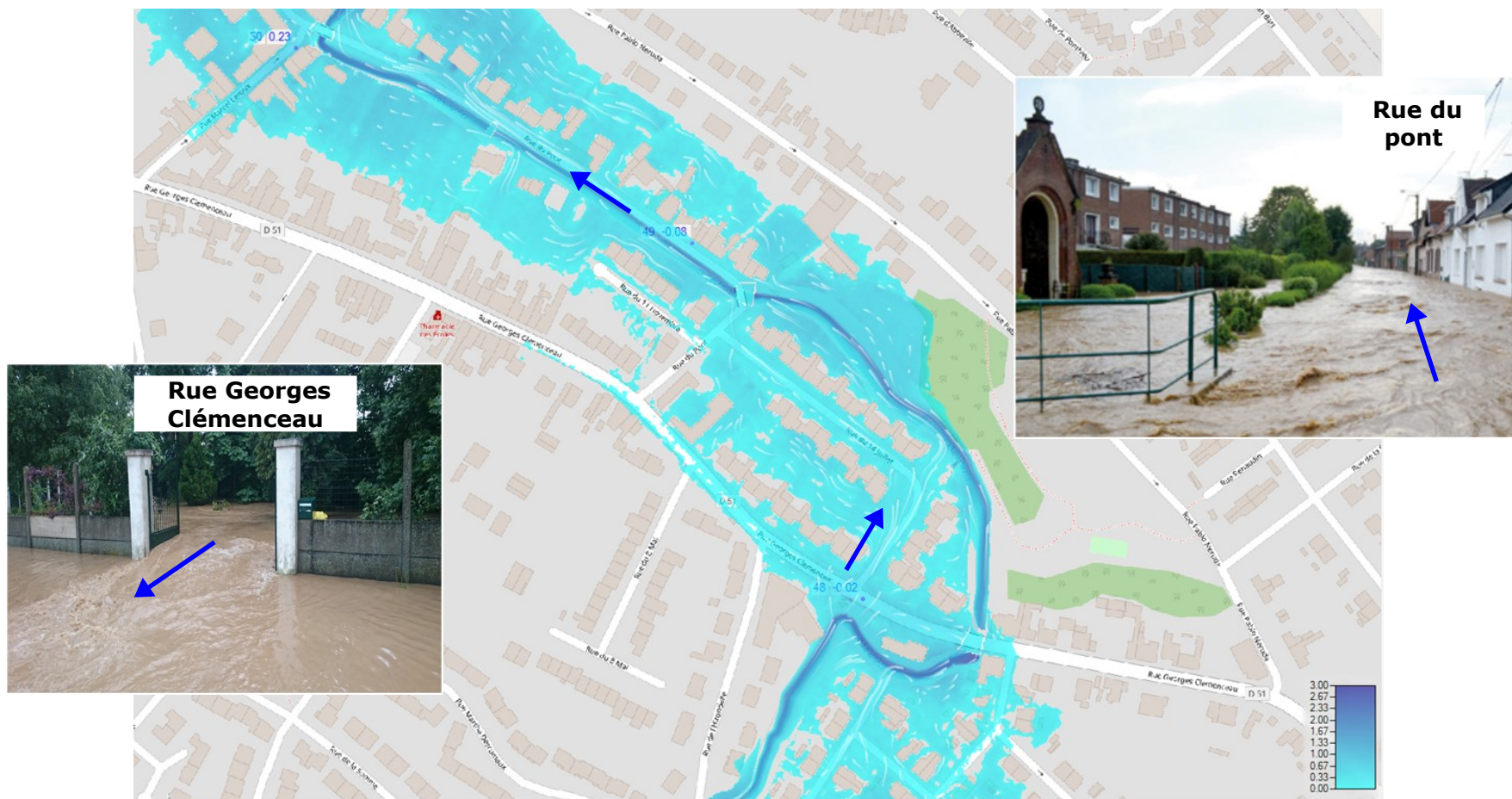
Figure 34: Axe d'écoulement rue du pont à Angres
