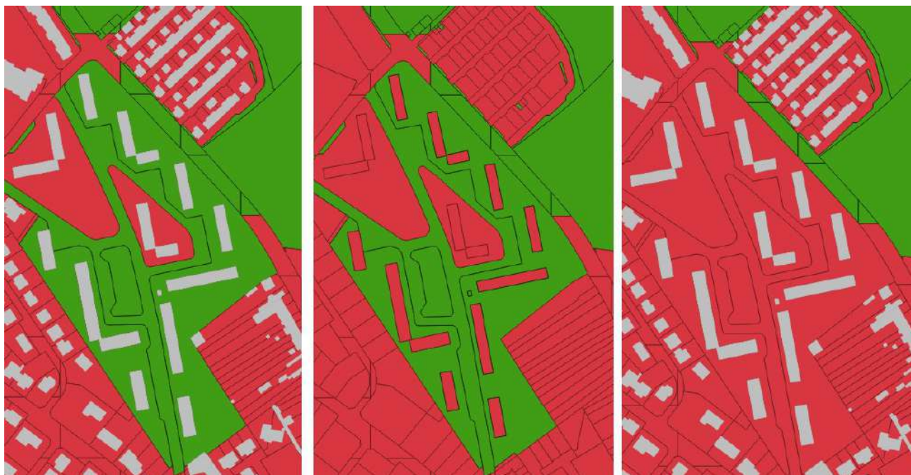
Figure 11 - À gauche le zonage à la fin de l'étape 4 avec le bâti superposé, au centre, le parcellaire sans le bâti ou on constate que les bâtiments de type collectif ont des contours identiques aux parcelles, à droite le zonage à la fin de l'étape 5 (source : IGN)
