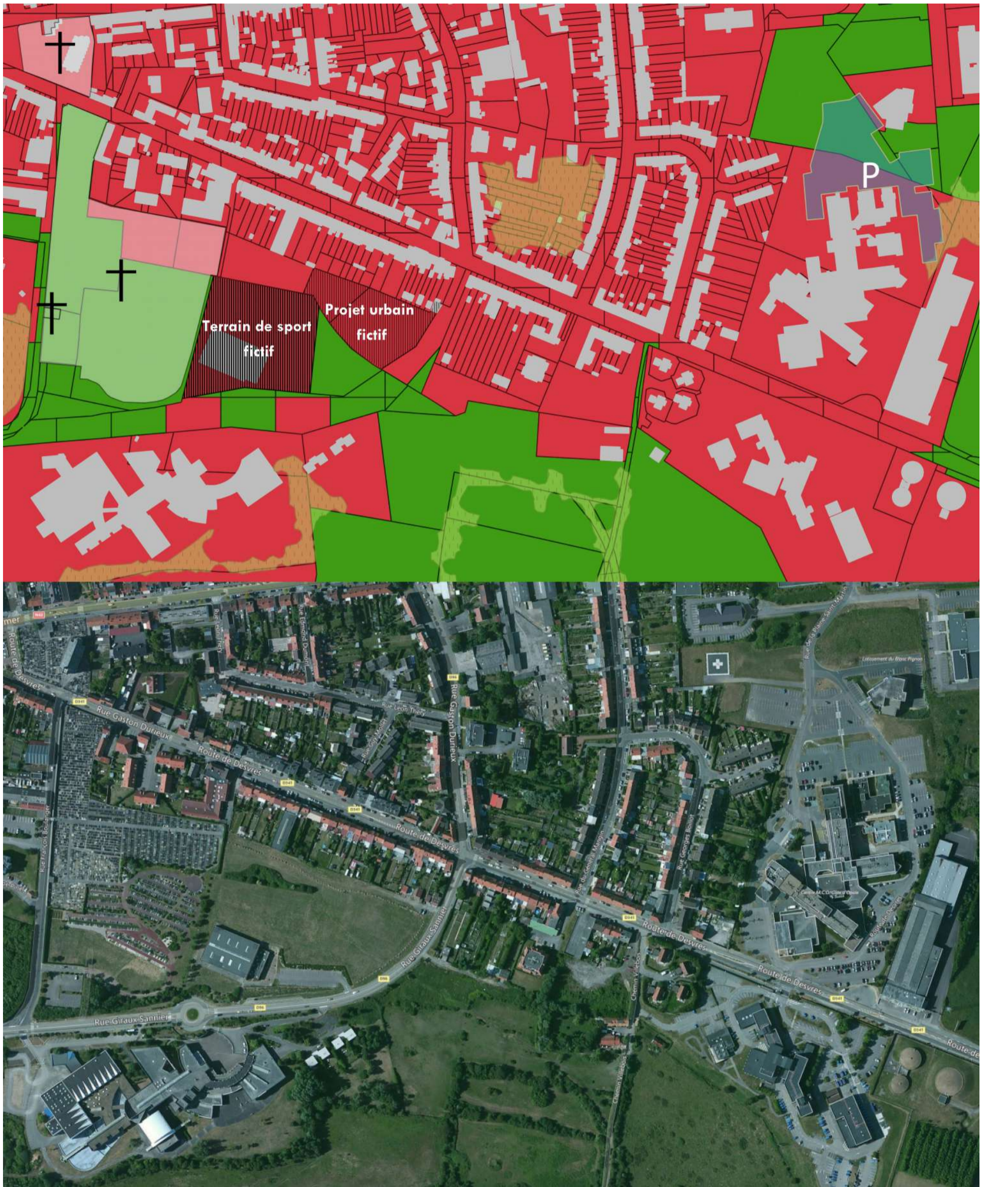
Figure 15 - En haut, le zonage à la fin de l'étape automatique avec la superposition des parkings, espaces naturels et cimetières, ainsi qu'un projet et un terrain de sport fictifs ; en bas, l'orthophotographie. Un traitement manuel est nécessaire sur certaines parcelles (source : Bing Aerial, IGN)
