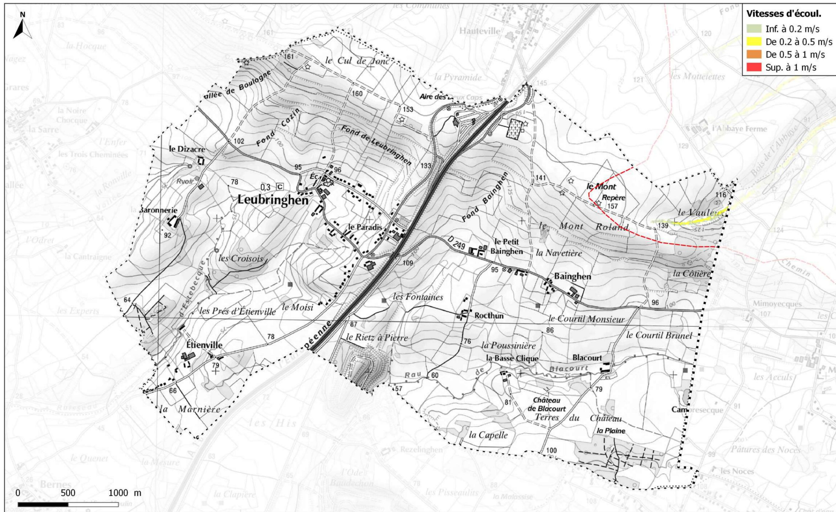
V - Cartographie des vitesses d'écoulement
