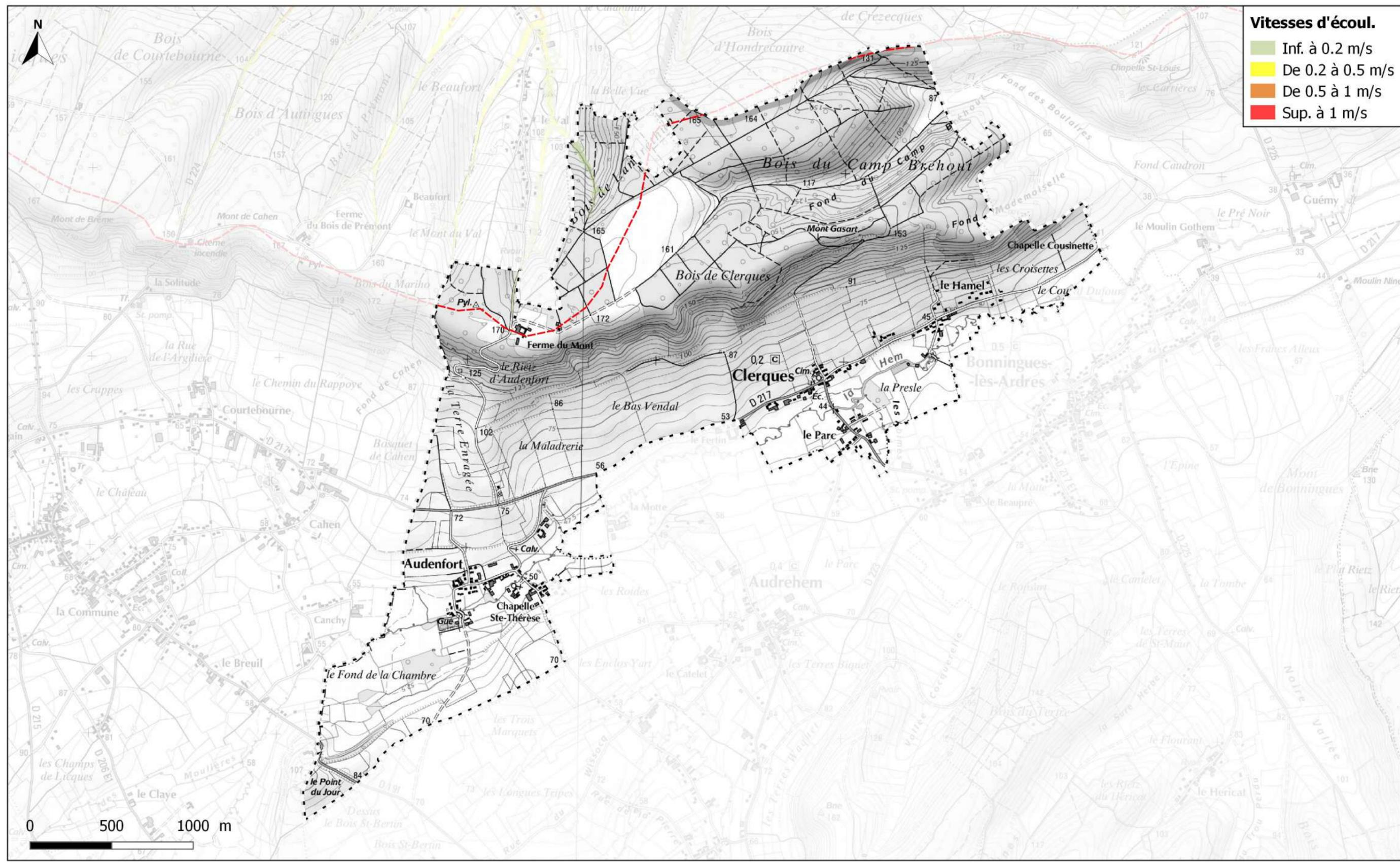
V - Cartographie des vitesses d'écoulement
