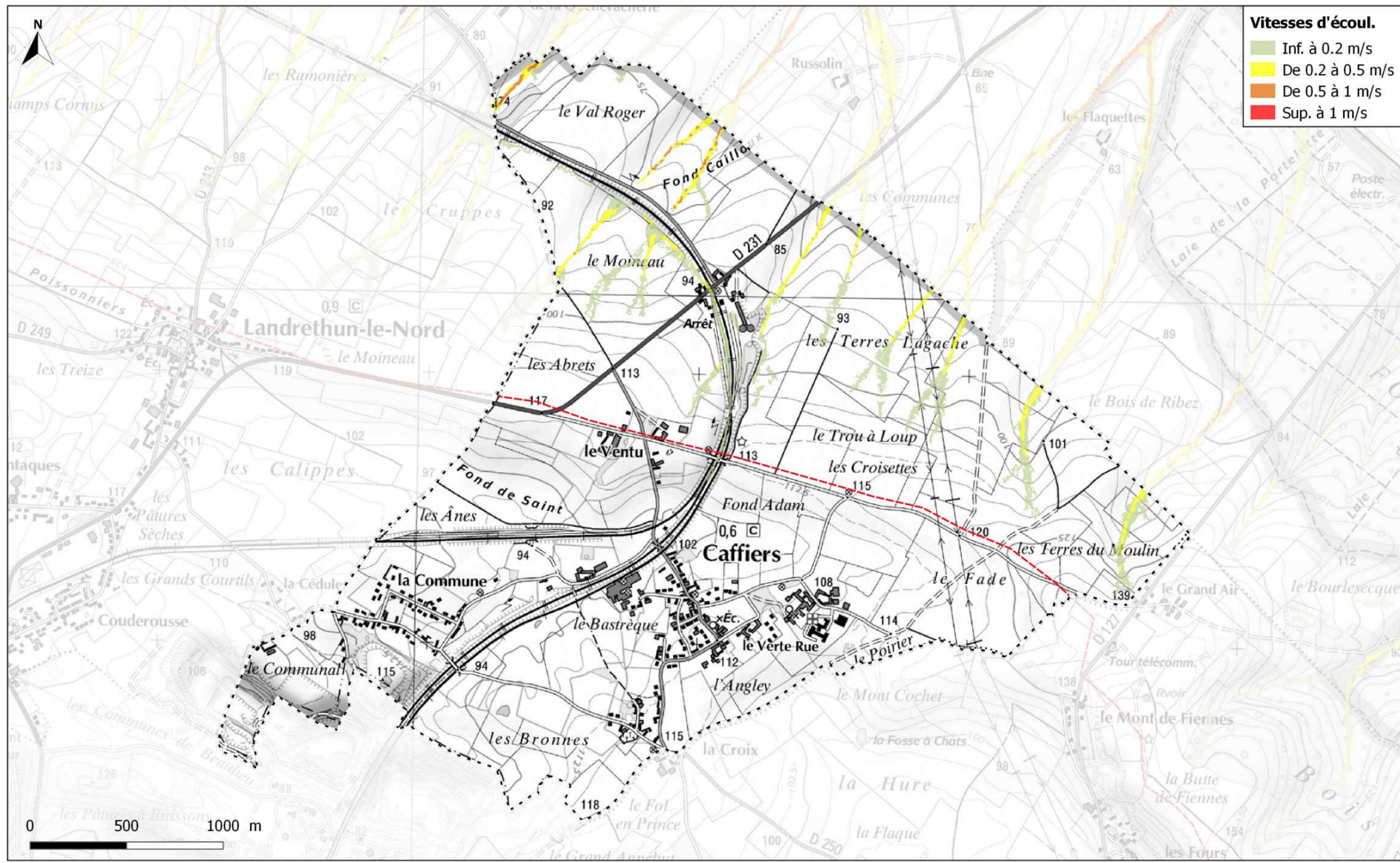
V - Cartographie des vitesses d'écoulement
