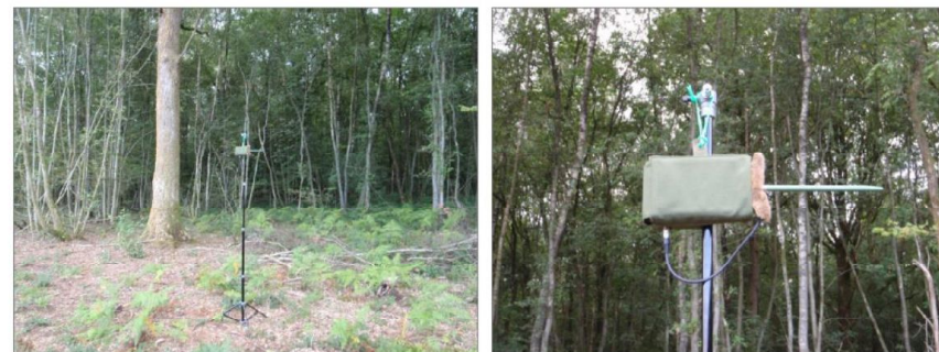
Figure 227 : Batcorder posé en point d'écoute fixe long (source : AXECO)
