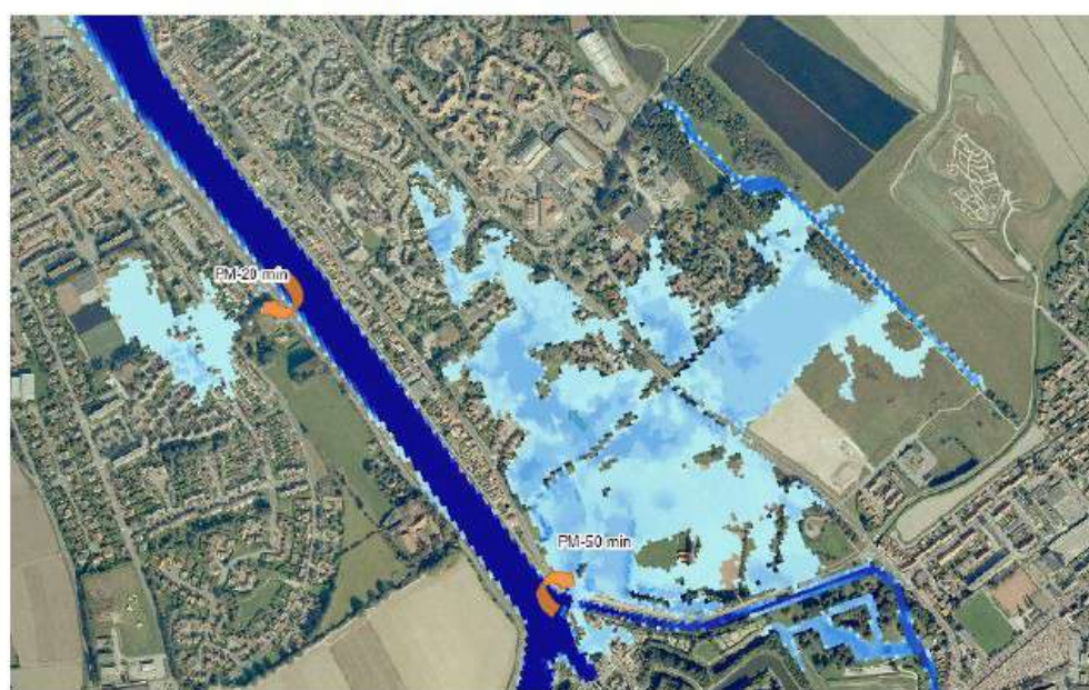
Figure 8-103 : Zone inondée 4 heures après la pleine-mer sur les rives de l'Aa et Petit-Fort-Philippe– en rouge rupture d'ouvrage en orange débordements (T100)
