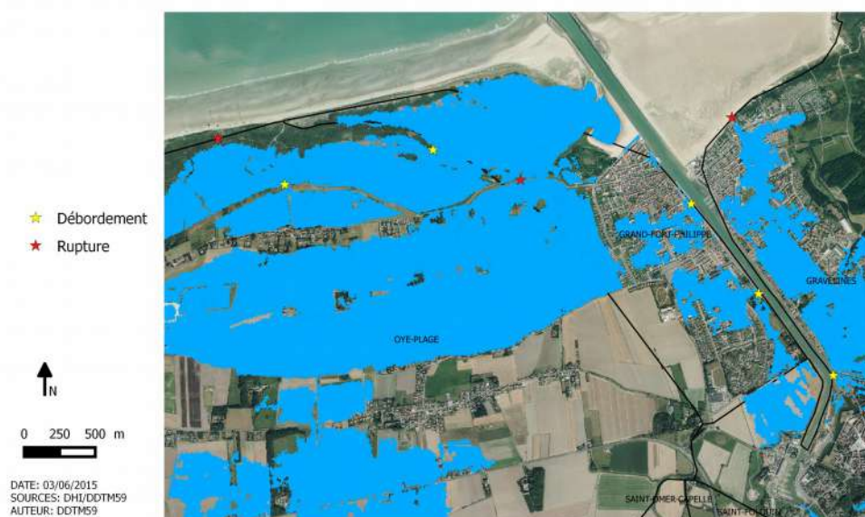
Illustration 32: Carte des entrées de la submersion modélisée (DDTM59, 2015)
