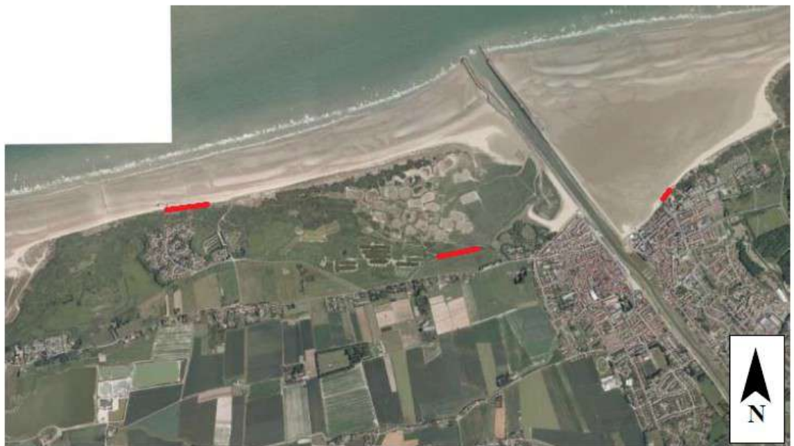
Figure 8-100 : Position des brèches simulées sur le secteur des rives de l'Aa
