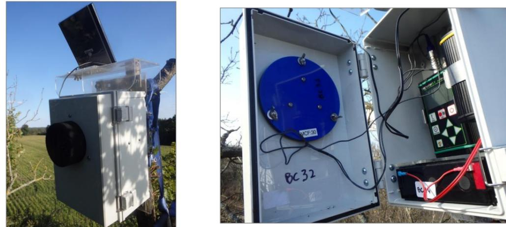
Figure 9 : Boîtier d'enregistrement autonome
