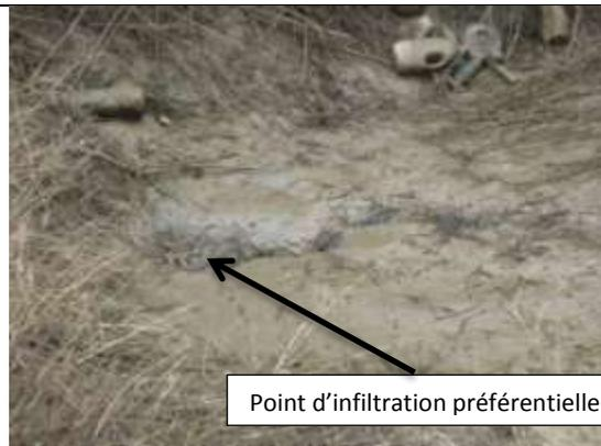
Photo 4 : Point d'infiltration préférentielle - puisard
