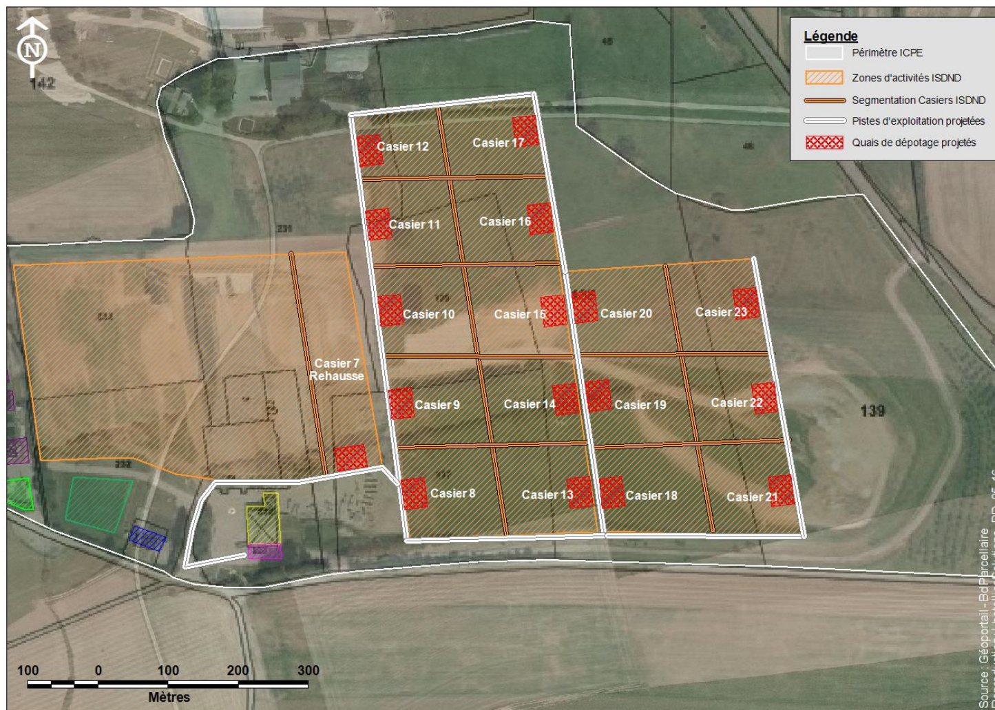
Figure 5 : Schéma de principe - Configuration d'exploitation des zones ISDND avec pistes et quais de dépotage
