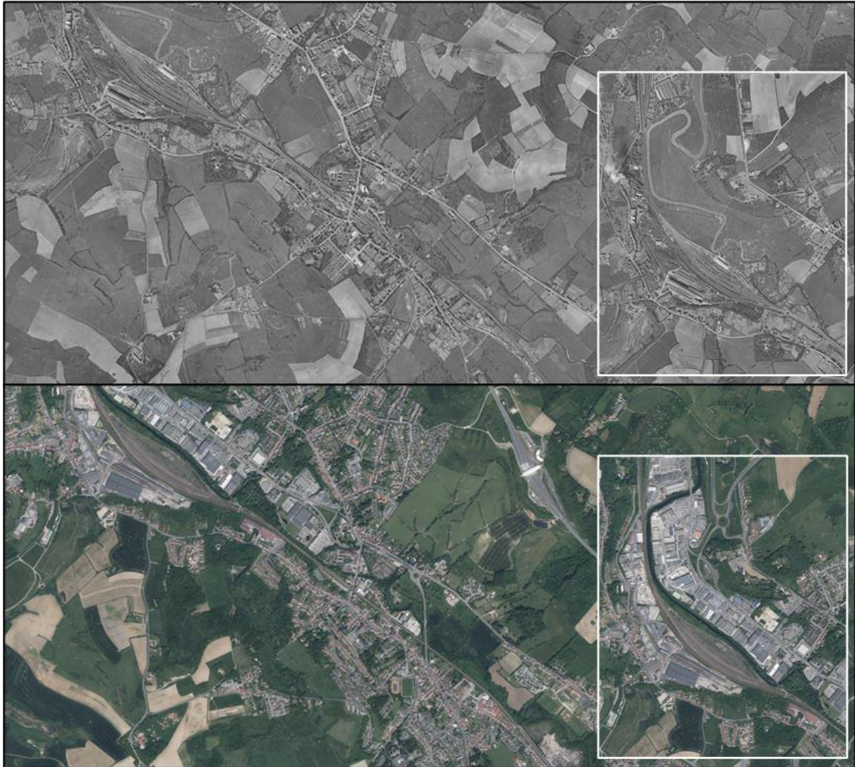
Illustration du développement urbain en limite directe de cours d'eau, voire dans le lit majeur entre 1950 (haut) et 2022 (bas). Le zoom à droite de chaque partie montre, au-delà de l'installation dans le lit du fleuve, la rectification d'une partie de son cours. Source : IGN.
