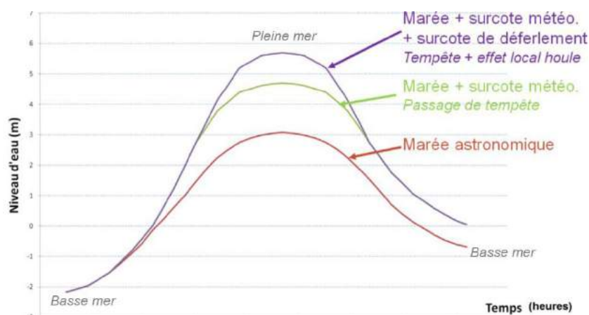
Effet d'une surcote météorologique et d'une surcote de déferlement sur le niveau de pleine mer
