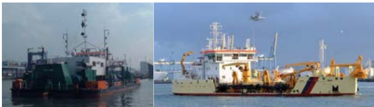
Figure 2-83. Equipements de dragage sur le site portuaire de Boulogne-sur-Mer (drague à injection d'eau (Jetsed) et drague aspiratrice en marche (Jean Ango)).
