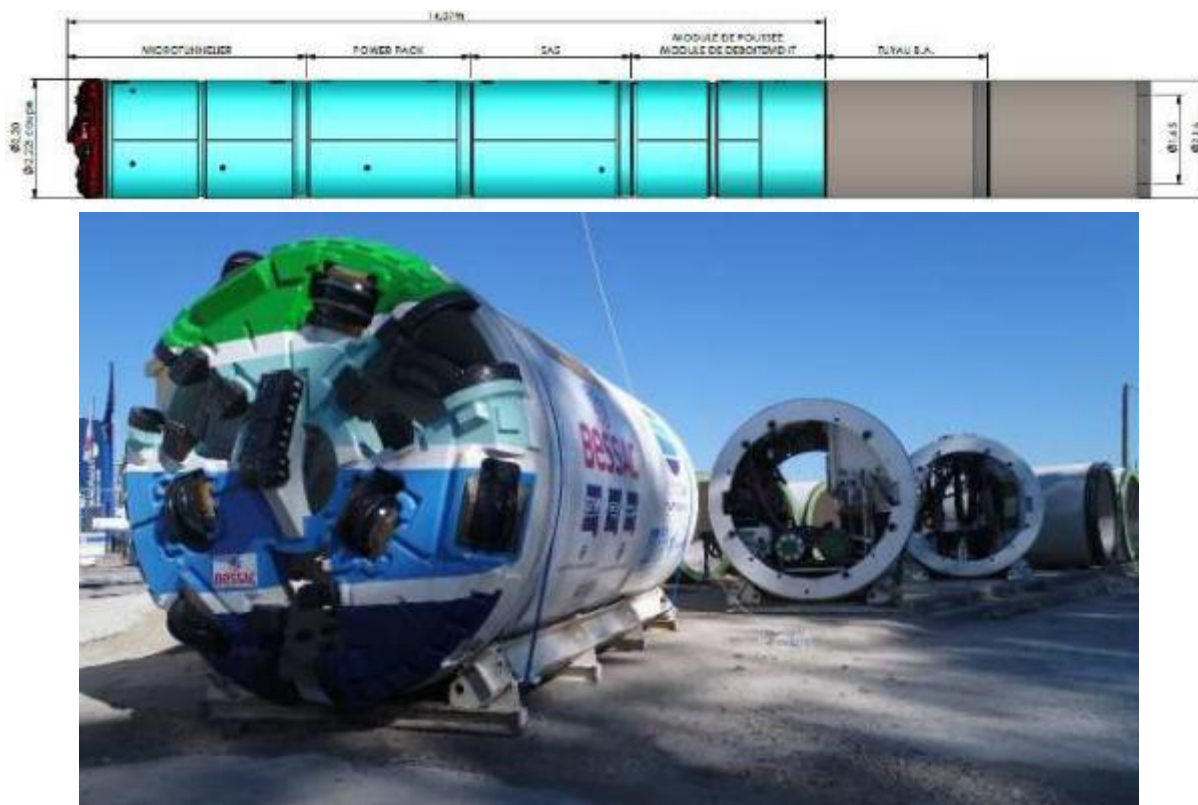
Figure 3-8. Illustration de la technique du microtunnelier.
