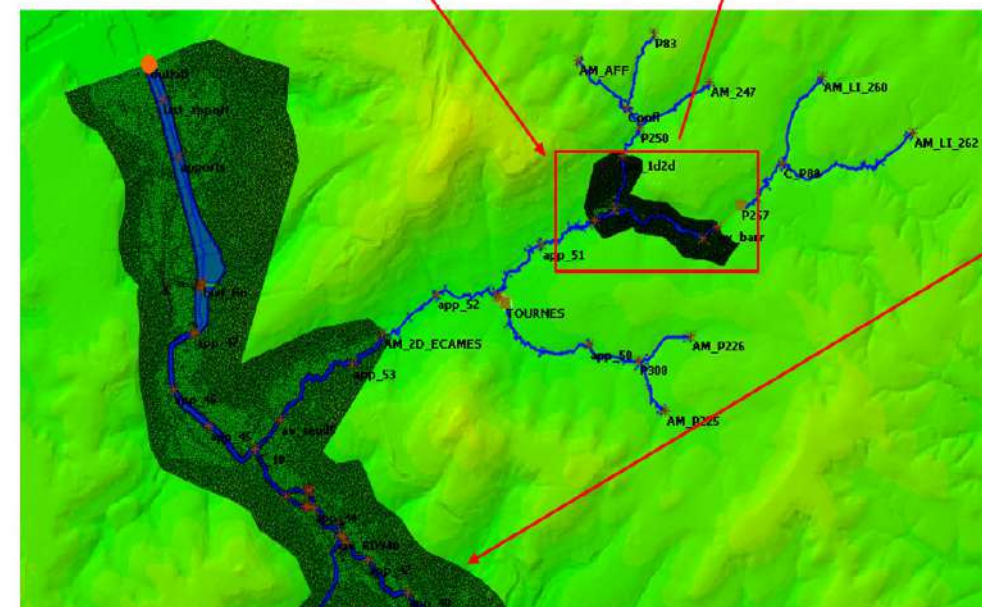
Figure 9 : Deux type de modélisation des écoulements en zones inondables (Liane aval)
