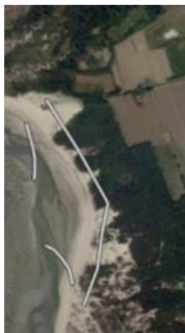
Fig. 16. Option 1 (gauche) : Réensablement massif, maintien du trait de côte à minima à son emplacement actuel / Option 2 (droite) : Création d'une digue en position rétro-littorale.
