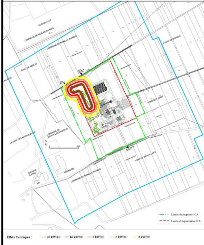
**KAL 23 – JEV – Fuite de 70 mm sur la canalisation enterrée DN 250 turbine en amont du poste compression – détente**
